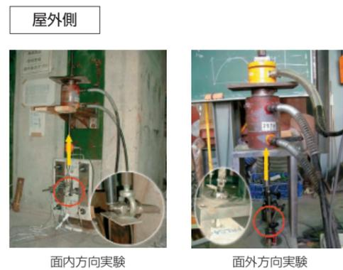
シャフトの面内方向、面外方向実験により自然外力に対応できるシャフトの許容荷重を確認。実験から仕上げ材料の重さとシャフトの本数の関係が確定できた。
